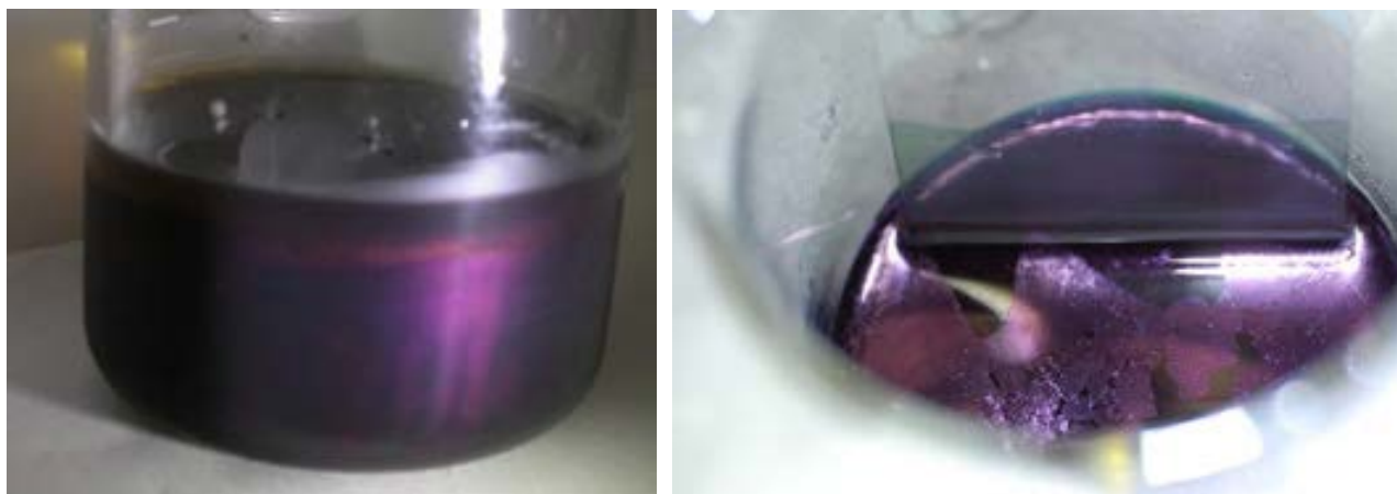
図4 長時間（24時間）の重合による紫色のポリアニリンの生成
