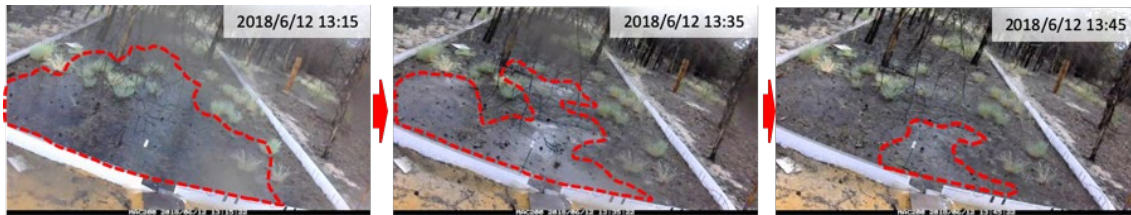
図2 森林火災跡地に設置された調査区での地表流の観測。赤破線で囲われた部分は土壤に雨水が吸収されきれずに地表流が発生。時間と共にその面積が変わっていることが分かる。
