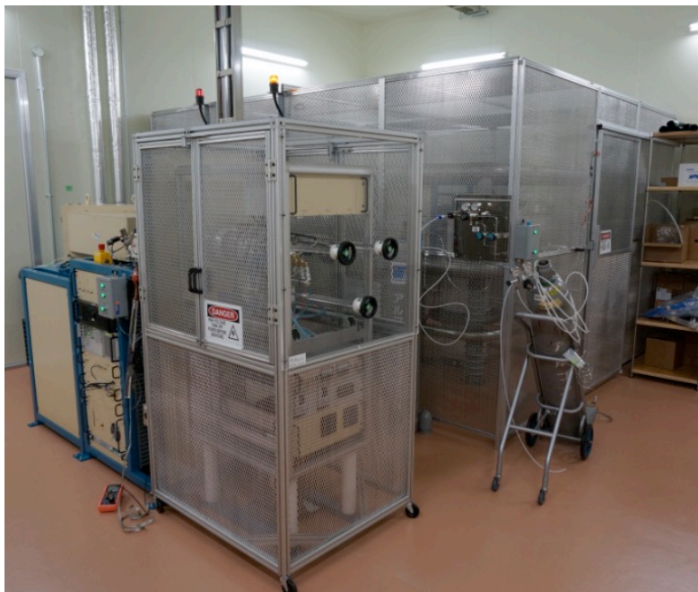
図3：東京大学大気海洋研究所にて稼働しているシングルステージ加速器質量分析装置
