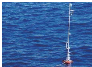
PTR-MS/GF法に使用したプロファイリングブイ。海洋直上の大気を採取するために、プロファイリングブイには、高度5cm～2mまでの高さに大気採取用インレットを設置してある
