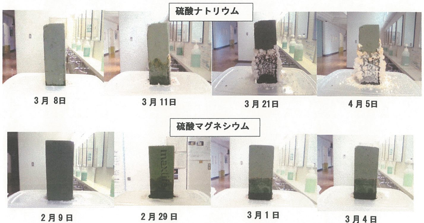
写真10 硫酸ナトリウムと硫酸マグネシウム飽和水溶液に浸した園芸用スポンジの変化
