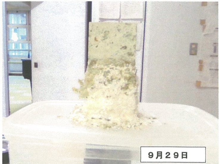
写真4a 硫酸ナトリウムの場合 2回目の実験の経過（2023年9月22日～9月29日）
