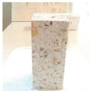
写真1 プラ容器にセットした緑色凝灰岩の角柱(角柱の1/3弱はフタの下の水溶液に浸っている)
