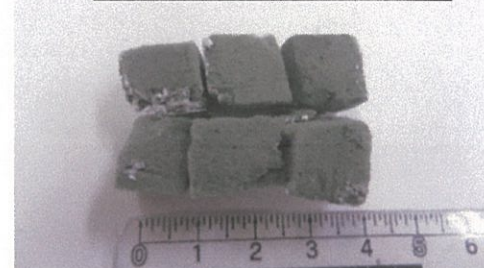
プラ容器のフタの面から1 cmの高さで切ったスポンジを6等分した状態
