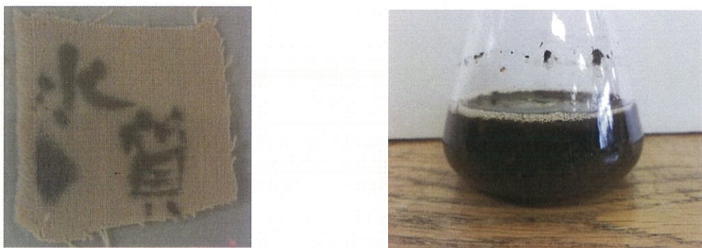
Fig.1 鉄イオンとポリフェノールを用いた布の黒染め (左) と 太陽光に当たった染色液が泡立つ様子 (右) .
