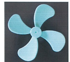
Fig.5: 実験用プロペラ ダイワプロペラ 直径11cm プロペラ厚さ1.4mm
