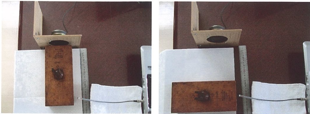
[図 6] スピーカーを取り付けた板から 10 mm の位置に開口部があるように設置した音叉
